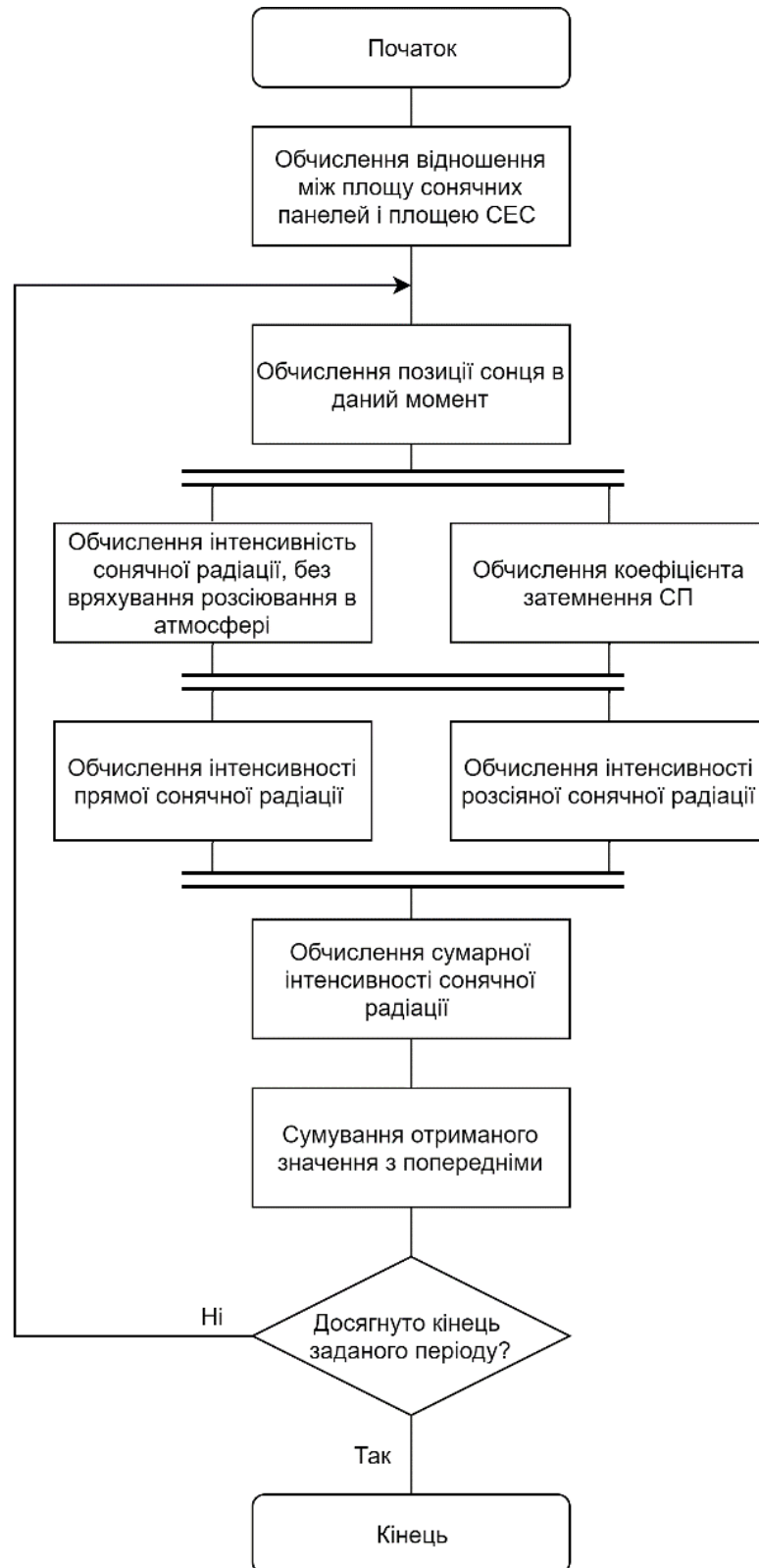
Рис. 2.15 Блок-схема знаходження сумарної інтенсивності сонячної радіації
