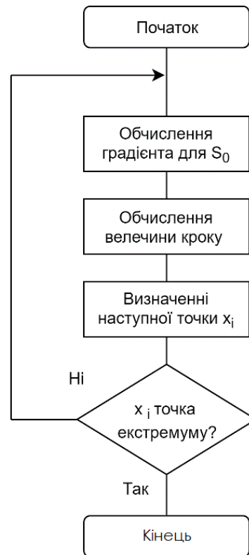
Рис. 2.16 Блок-схема градієнтного методу сходження з подрібненням кроку
