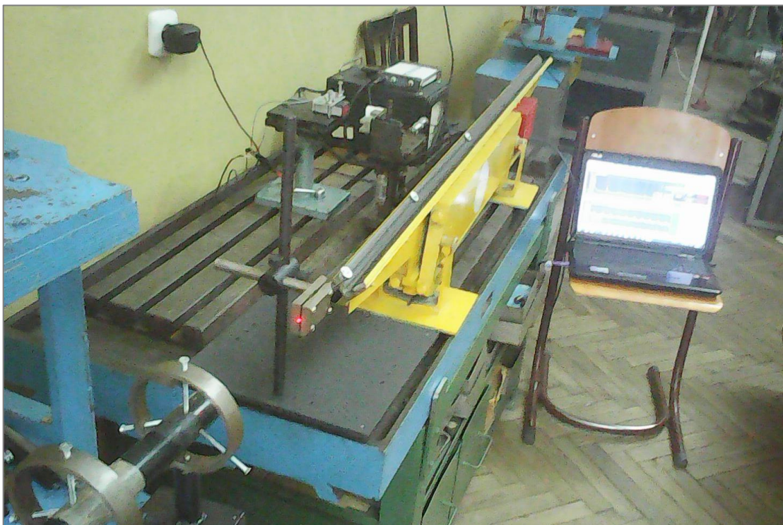
Рис. 4.18. Експериментальна установка для дослідження амплітудних та частотних характеристик вібраційного лотка-транспортера з використанням інтерферометра на основі ПОВ
