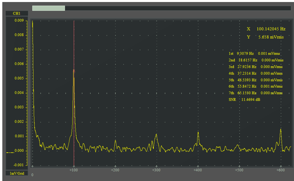
Рис. 4.20. Спектр вихідного сигналу інтерферометра встановленого на поверхні лотка-транспортера з частотою вібрації 100 Гц
