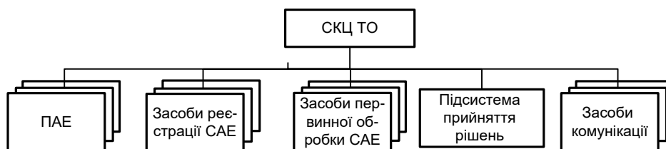
Рисунок. 5.42 – Структура системи контролю цілісності вузлових елементів ЛЧ МГ
