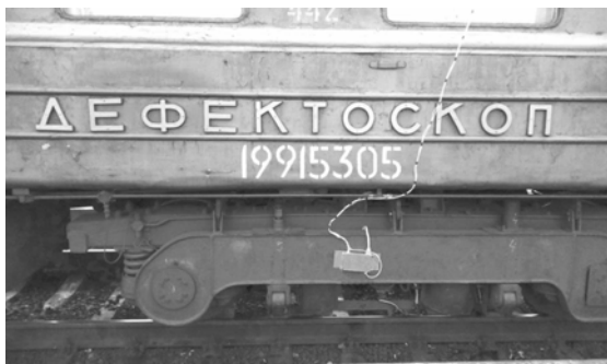
Рис. 7. Розміщення складових макета інформаційно-діагностичної системи на вагоні-дефектоскопі
