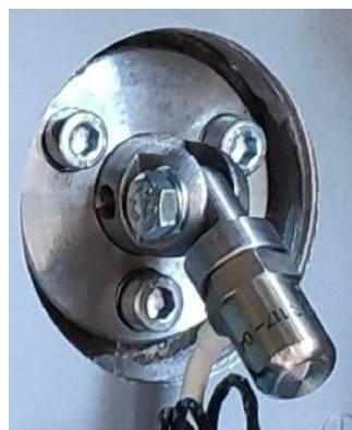
Рис.А1.13. Регульований ( a ) та нерегульований ( б ) перехідник під акселерометр, розміщений всередині SKWM-001.
