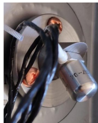
Рис.А1.13. Регульований ( a ) та нерегульований ( б ) перехідник під акселерометр, розміщений всередині SKWM-001.
