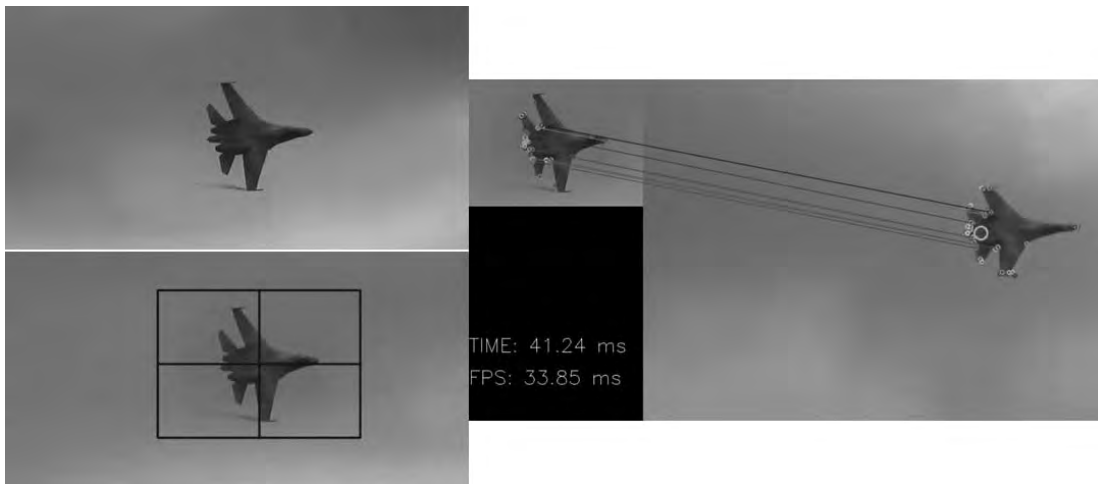
Рис. 3. Скріншоти екранів вхідного кадру, еталону та виявленого об'єкта за методом особливих точок детектора ORB
