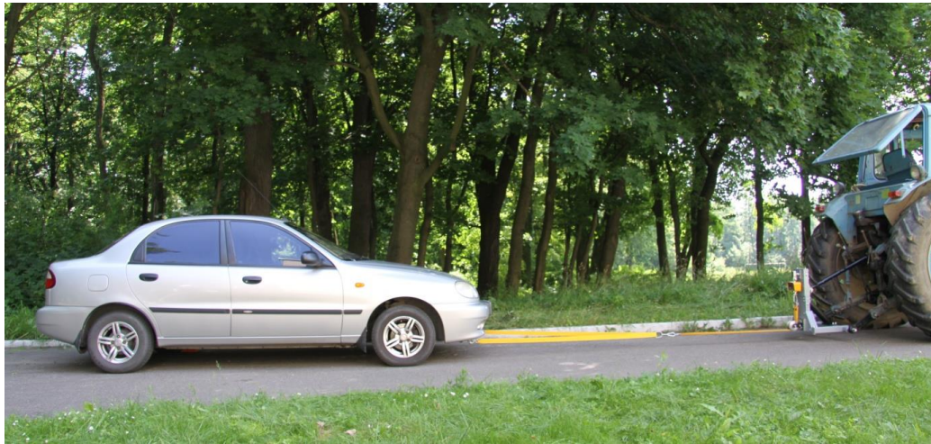
Рис. 1. (продовження). Визначення коефіцієнта опору коченню та тягово-зчпних показників автомобілів: в – фрагмент дорожніх випробувань
