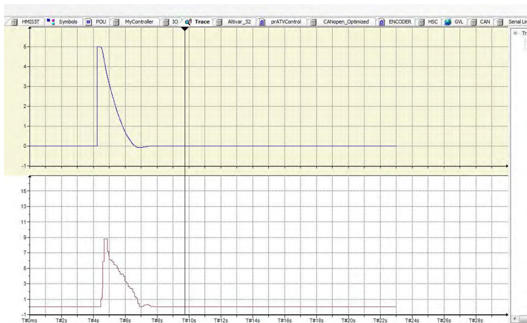
Рис. 9. Похибка положення вала двигуна (верхня крива) та частота напруги статора (нижня крива) з параболічним П-регулятором положення із коефіцієнтами K=100
