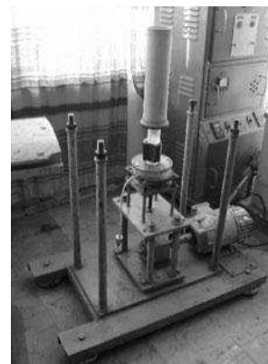
Рис. 1. Загальний вигляд дослідної вібраційної кавітаційно-магнітної установки на основі гідропульсатора
