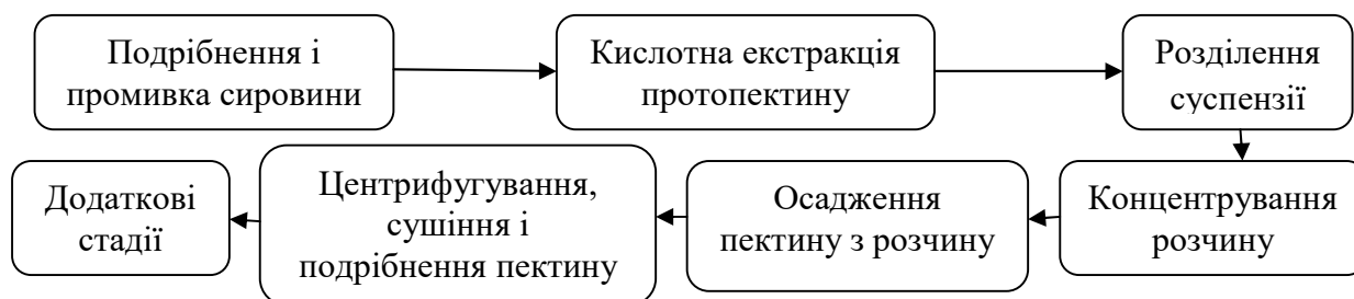
Рис. 1. Схема технології виробництва пектину [1]
