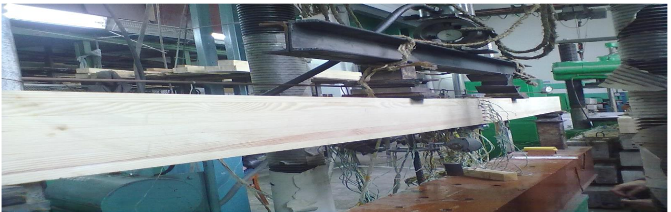
Рис. 14. Загальний вигляд дослідної установки при випробуванні балки на поперечний згин
