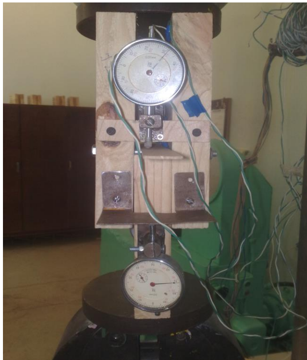
Рис. 10. Процес випробування нагельного з'єднання
