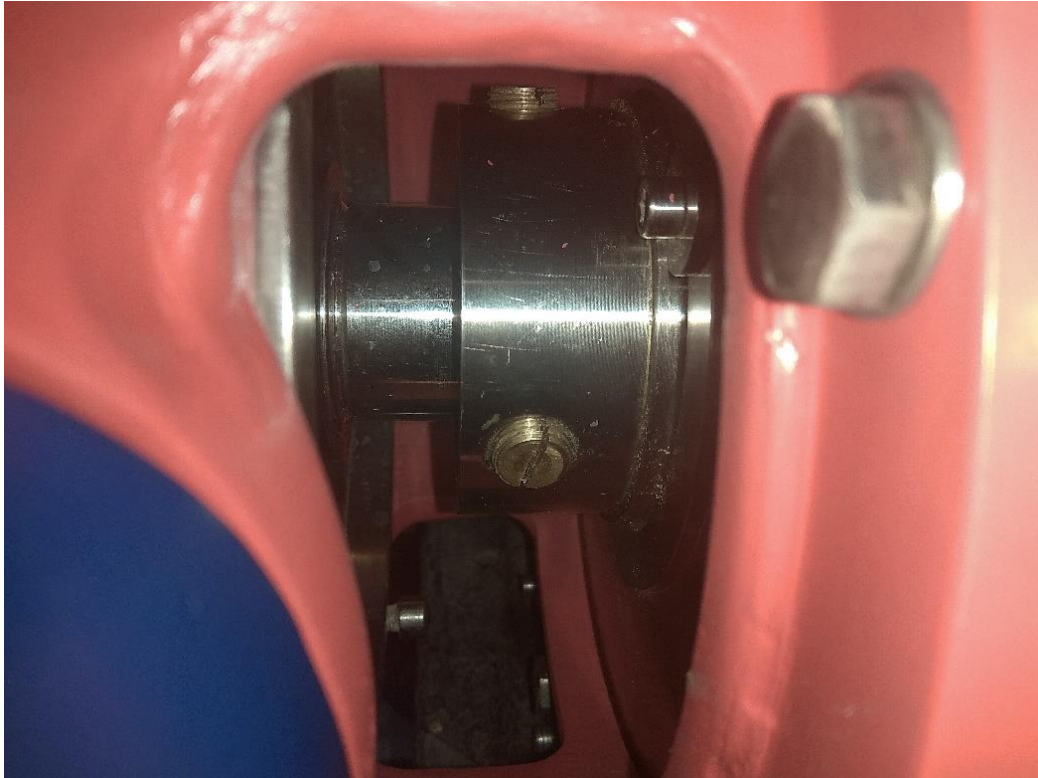
Рис. 4.2. Фіксація основного порожнистого валу, для дослідження статичної характеристики торсійного елемента ротаційного концентратоміра паперової пульпи.
