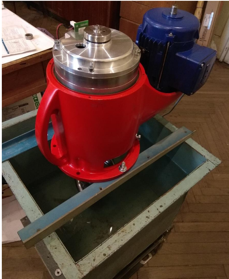
Рис.4.12 Фото лабораторної установки для дослідження датчика для вимірювання кута повороту чутливого елемента ротатійного концентратоміра паперової пульпи
