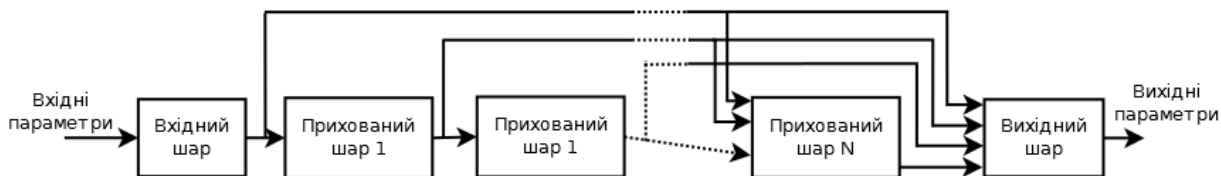
Рис. 2.24. Схема поширення інформації в нейронних мережах Cascade-forward
