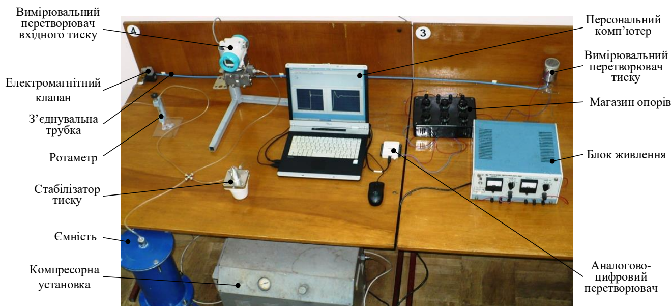
Рис.3.2. Експериментальна установка для дослідження динамічних характеристик пневматичного каналу перетворювача тиску
