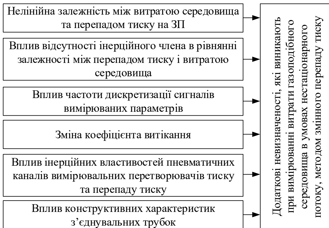
Рис.2.6. Класифікація причин виникнення додаткових невизначеностей при вимірюванні витрати газоподібних середовищ методом змінного перепаду тиску в умовах нестационарного потоку.
