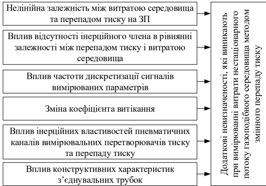
Рисунок 2. Класифікація причин виникнення додаткових невизначеностей при вимірюванні витрати газоподібних середовищ методом змінного перепаду тиску в умовах нестационарного потоку.
