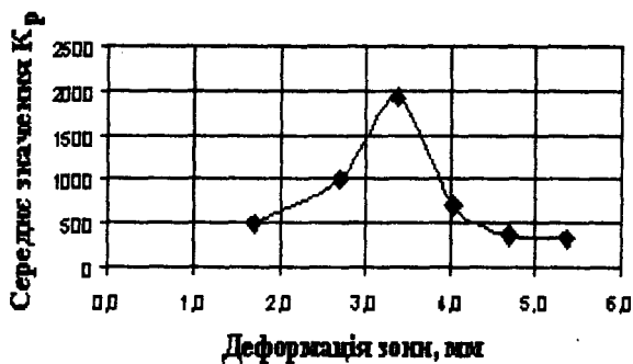
Рис. 4. Залежність K_p від деформації зони ЦОН
