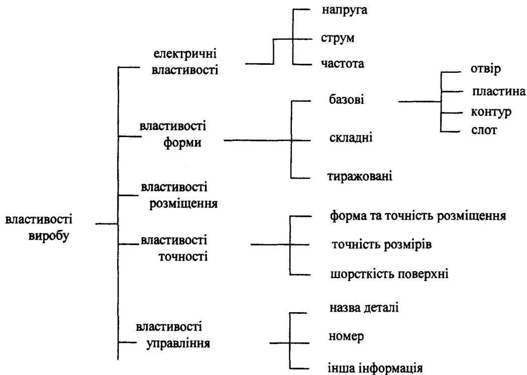
Рис. 5. Інформаційна модель структури рівня класів для елемента деталі
