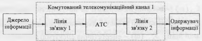
Рис. 1. Найпростіший комутований телекомунікаційний канал 1
