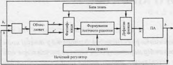
Рис. 1. Структура системи керування з нечітким регулятором: h_s – задана висота руху ПА над ґрунтом; h – фактична висота руху ПА над ґрунтом; e, e', e'' – похибка керування та її похідні; u – керівний вплив
