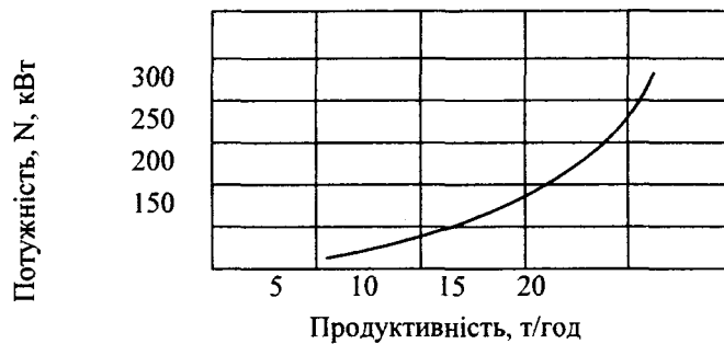
Рис. 2. Залежність спожитої потужності при розмелюванні пісного вугілля від продуктивності млина МВС-140А.
