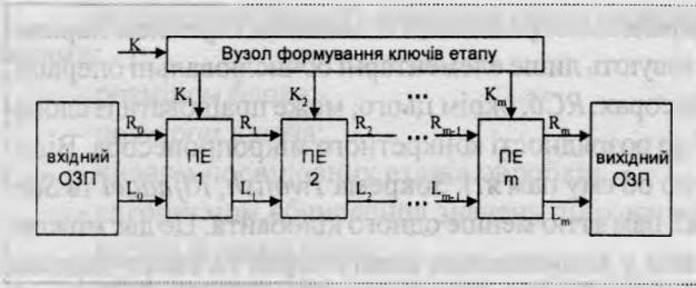
Рис. 3. Структура конвеєрного криптопроцесора на основі схеми Файстеля
