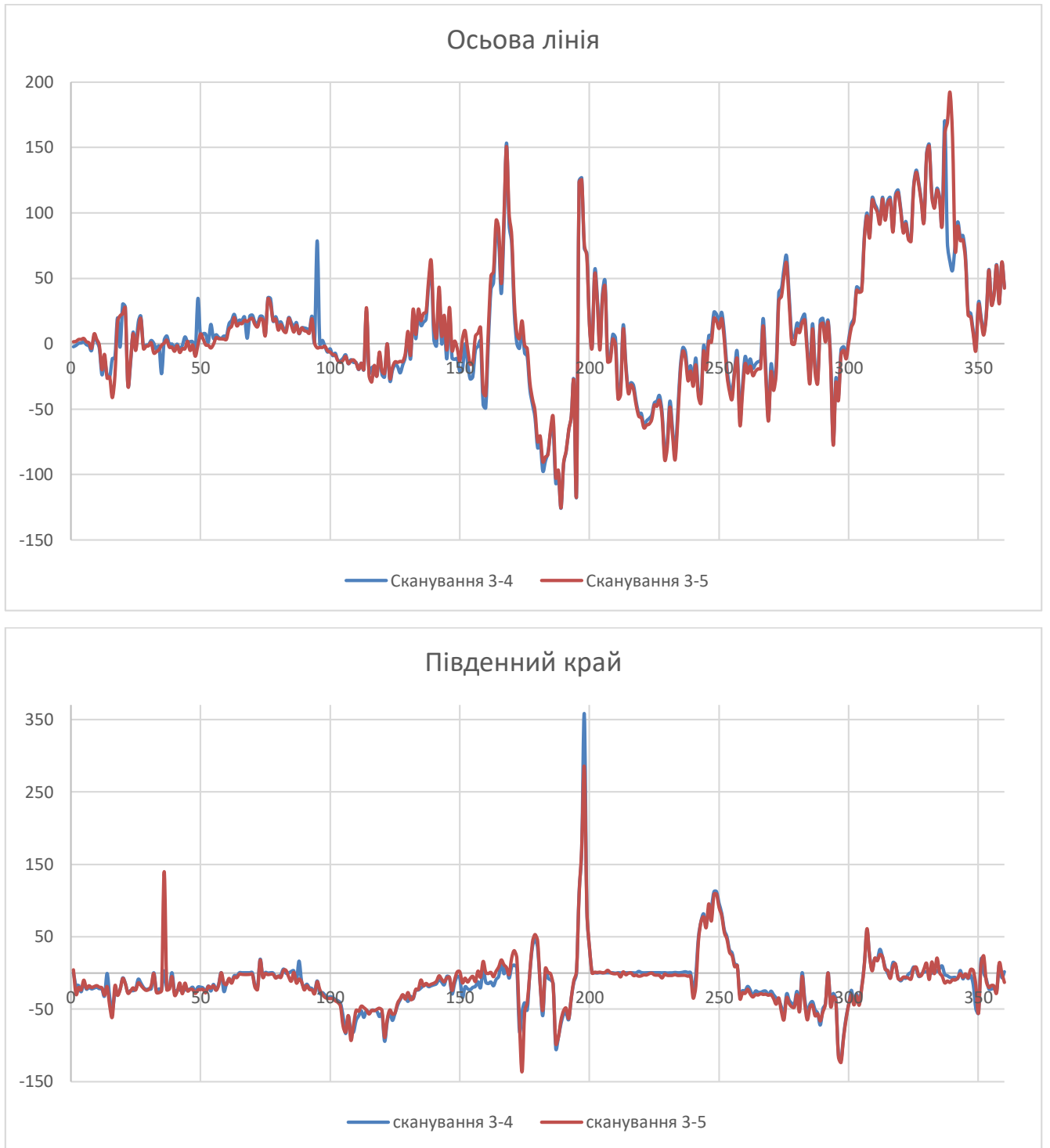
Рис. 4.28 Графіки зміщення положення центра та південного краю автодороги
