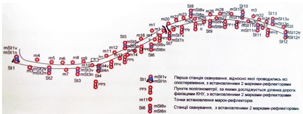
Рис. 4.9 Схема закладки точок тимчасової знімальної мережі
