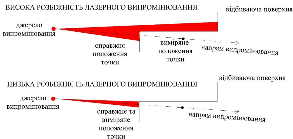
Рис. 2.1 Помилки у вимірюванні відстаней, викликані високою розбіжністю лазерного випромінювання
