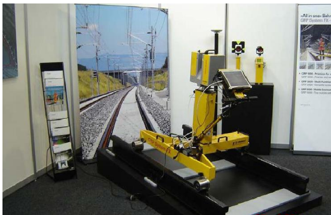
Рис. 2.4 Система сканування залізничної колії
