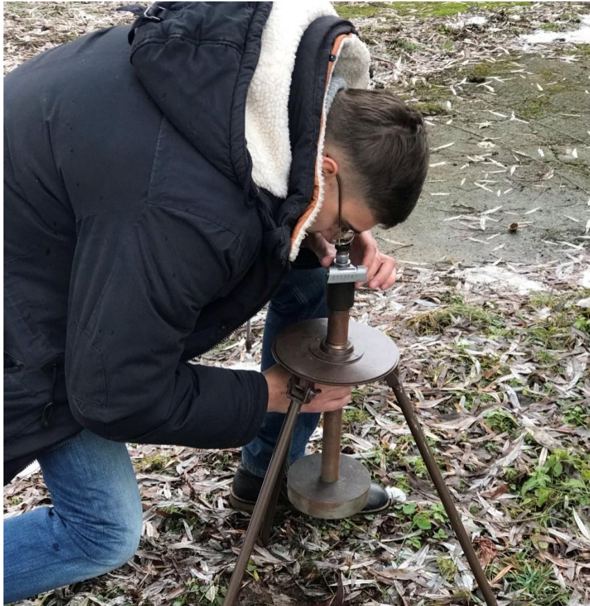
Рис. 3.10 – Центрування пристрою для центрування геодезичних приладів над пунктом
