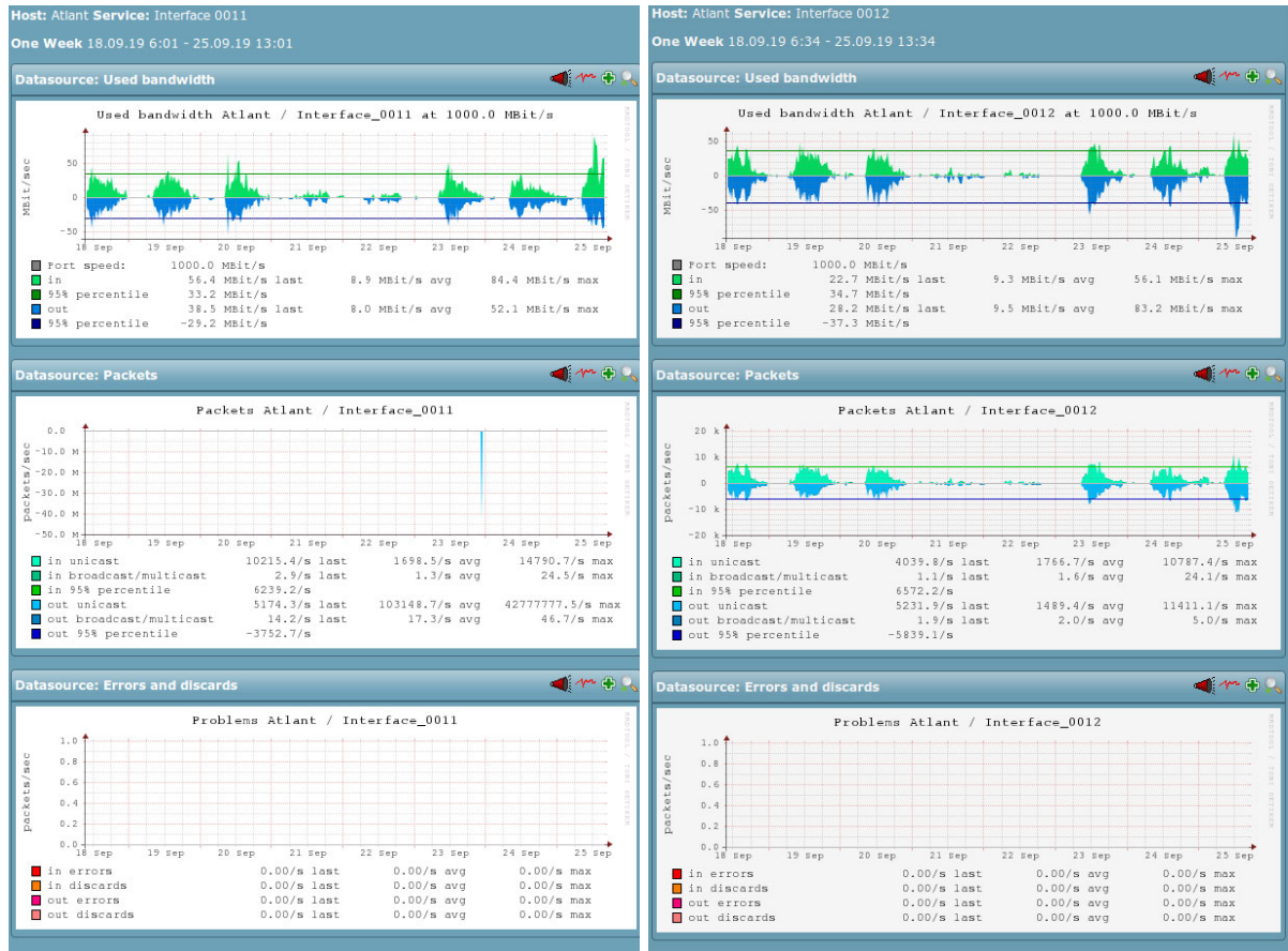
Рис. 4.6 Статистика вхідного та вихідного навантаження на порти 1, 2 контролера Cisco 5508 протягом тижня
