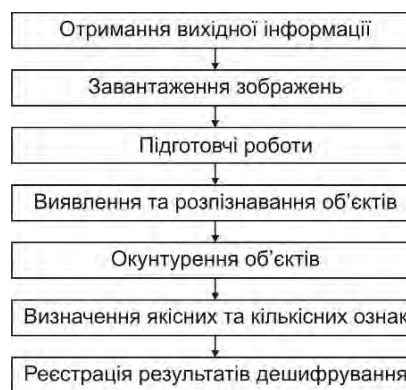
Рис. 1. Технологічна схема дослідження об'єктів земної поверхні за матеріалами аерокосмічного знімання [4]
