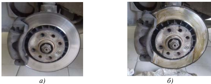
Рис. 2. Гальмівні механізми без забруднення (а) та після забруднення (б)
