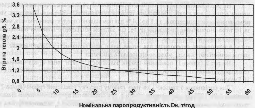
Рис.1 Нормативний графік визначення втрат тепла з q_5 котлами залежно від їх номінальної паропроодуктивності
