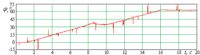
Рис. 2. Експериментальна часова залежність кута наведення \varphi(t) пакета напрямних бойової машини
