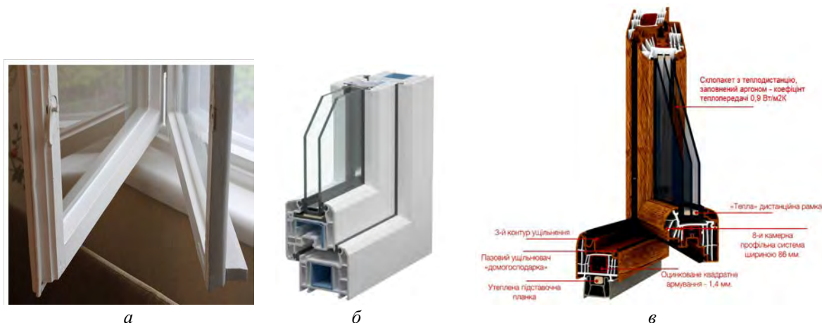
Рис. 4. Світлопрозорі конструкції: а – вікно подвійне в дерев'яних рамах ( R_{\Sigma пр} = 0,39 \text{ м}^2 \text{ К/Вт} ), б – пластикове вікно ( R_{\Sigma пр} = 0,75 \text{ м}^2 \text{ К/Вт} ), в – енергоефективне вікно ( R_{\Sigma пр} = 1,11 \text{ м}^2 \text{ К/Вт} )
