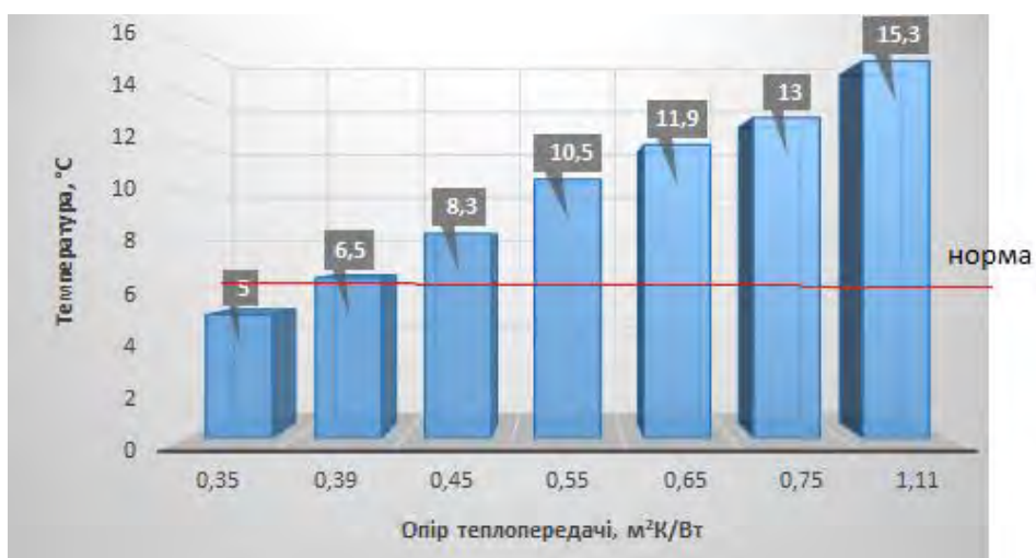
Рис. 3. Температура внутрішньої поверхні вікон різних типів
