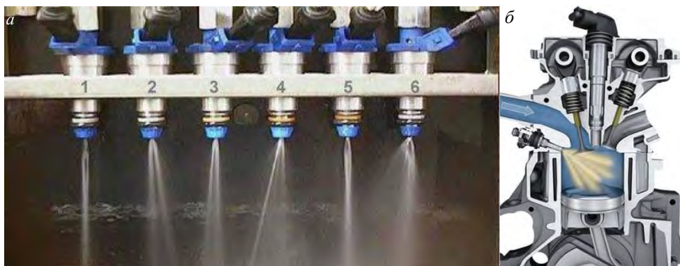
Рис. 10. Паливні системи двигунів внутрішнього згоряння: а – випробовування розподільної магістралі бензинового двигуна; б – впорскування пального в циліндр дизельного двигуна
