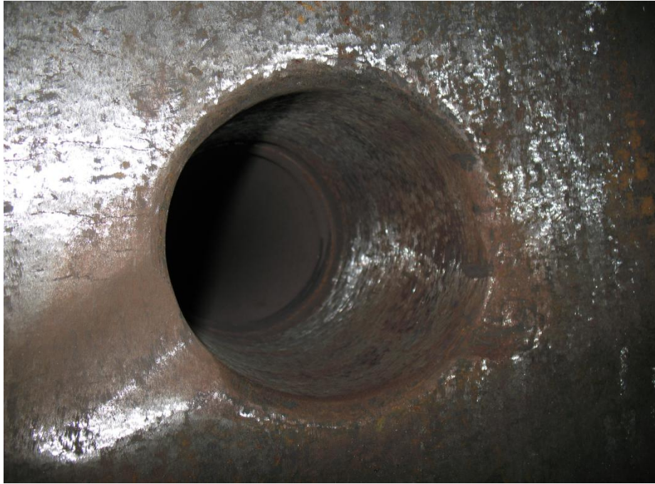
Рис. 3.67-в. Типові вибірки в околі отворів барабана котлоагрегату системи №18/ТП-100 конкретного блоку Бурштинської ТЕС, виконані за рекомендаціями роботи
