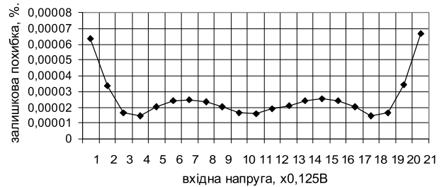
Рис. 6. Максимальні значення залишкової похибки нелінійності по діапазону вхідної напруги
