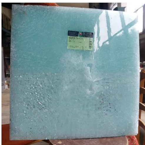
Рис. 3.23. Вигляди плит серії 6 після випробувань
