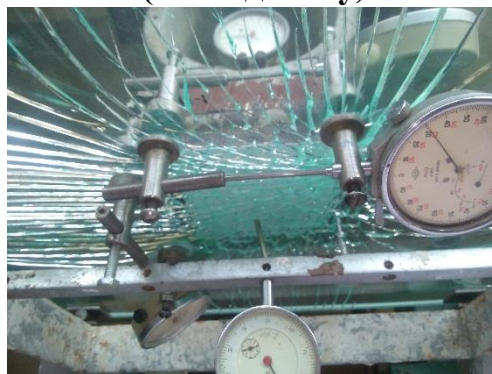
ПСБ-2.1, зруйнований середній шар (вигляд зверху) ПСБ-2.1, зруйнований середній шар (вигляд знизу)
