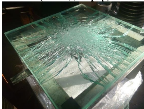
ПСБ-1.6, зруйновані всі шари (вигляд зверху)
