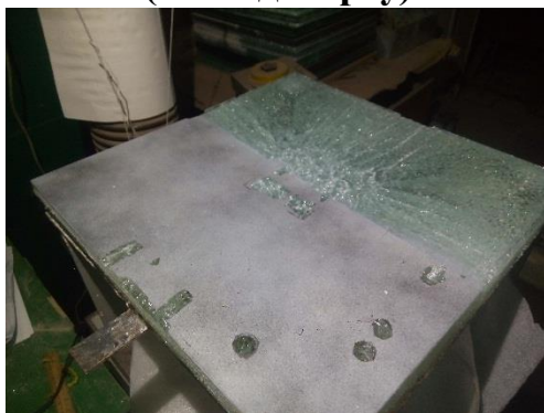
ПСБ-4.1, зруйновані всі шари (вигляд зверху)
