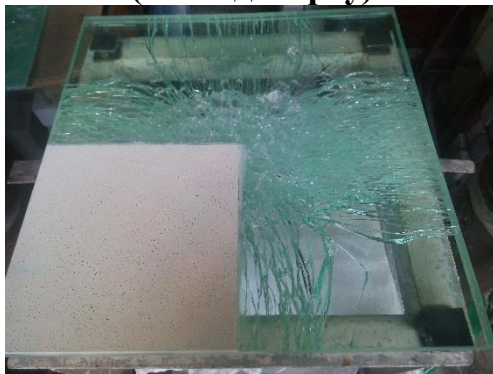
ПСБ-1.5, зруйновані всі шари (вигляд зверху)
