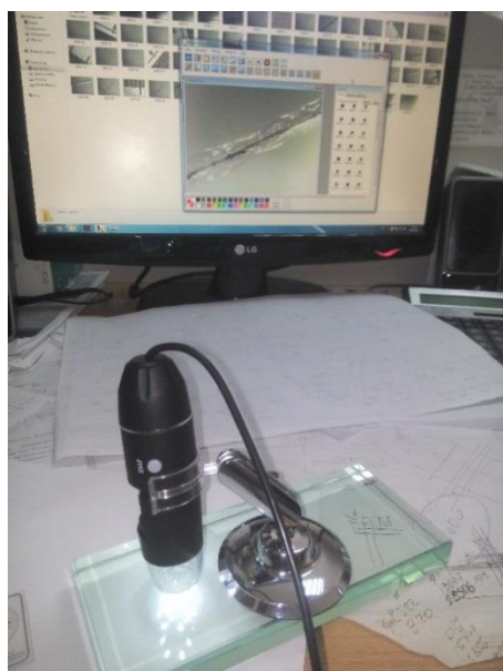
Рис. 2.18. Установка для дослідження поверхні скла
