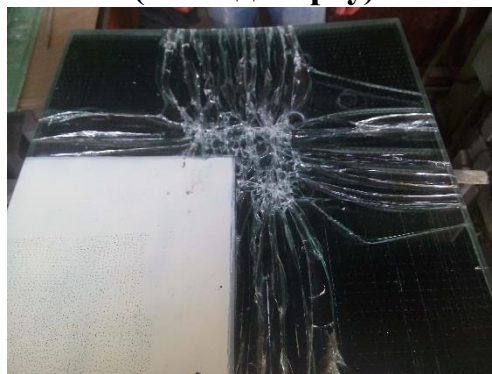
ПСБ-3.2, зруйновані всі шари (вигляд зверху)
