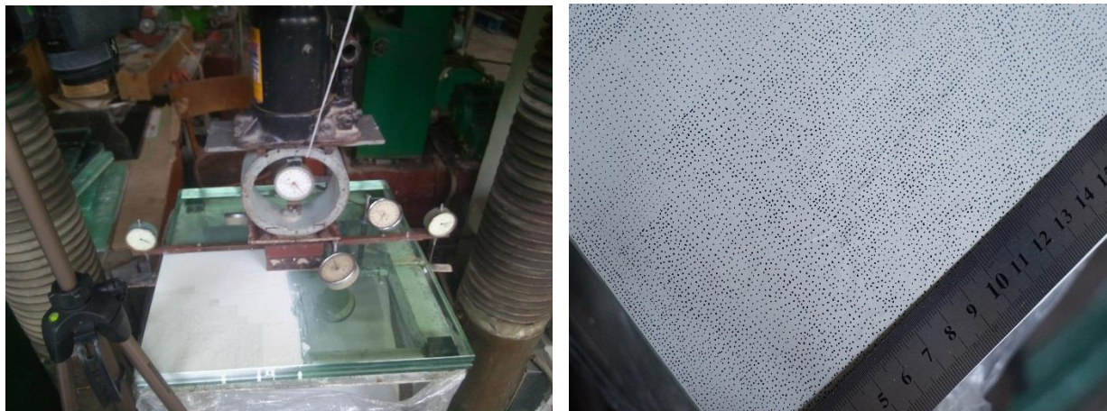
Рис. 2.7. Підготовка поверхні типового експериментального зразка для методу КЦЗ при ручному нанесенні стохастичної текстури:
