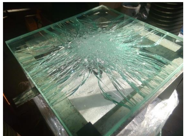
Рис. 4.9. Картина руйнування звичайного скла:
