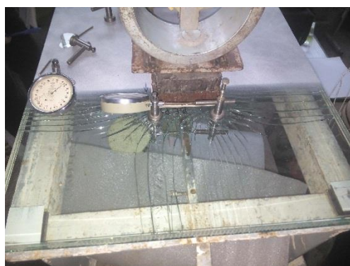
Рис. 3.10. Вигляди плит марок ПСБ-2.2 і ПСБ-2.3 після випробувань
