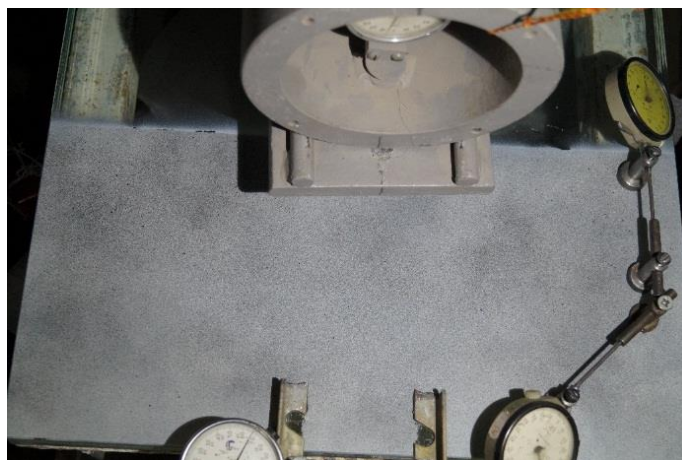
Рис. 2.11. Підготовка поверхні типового експериментального зразка для методу КЦЗ при нанесенні стохастичної текстури аерозольною фарбою
