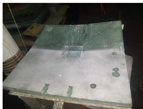
Рис. 3.10. Вигляди плит марок ПСБ-2.2 і ПСБ-2.3 після випробувань
