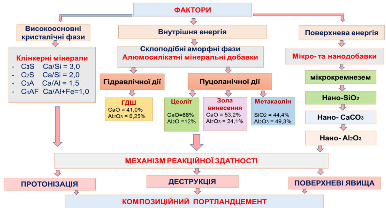
Рисунок 2.14 – Структурна схема впливу хіміко-мінералогічного складу та фізичних факторів на формування властивостей композиційних протландцементів
