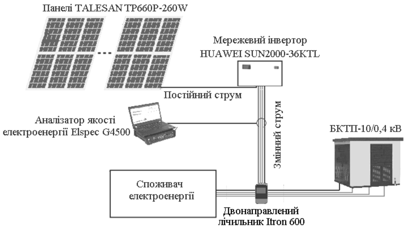
Рисунок 24 – Основні елементи мережевої сонячної електростанції потужністю 30 кВт та схеми проведення дослідження
