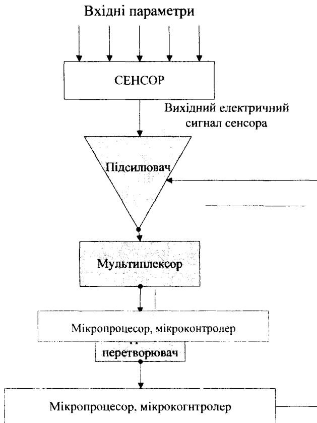
Рис. 2. Блок - схема детектора руху з цифровою обробкою сигналу
