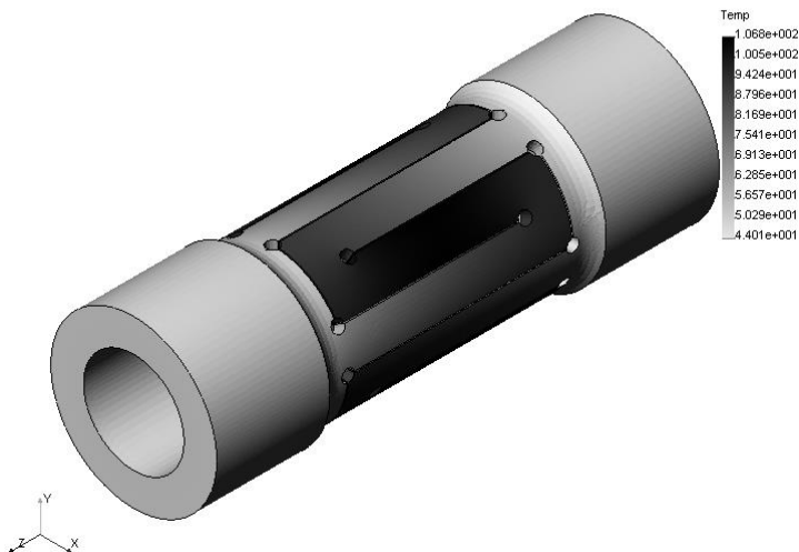
Рис. 5. Тепловий розрахунок муфти МСЕ за допомогою ЕОМ
