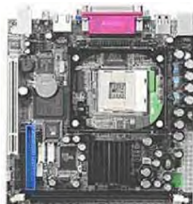
Fig 2. Pentium 4 Mini ITX board with intel 845GV chipset
