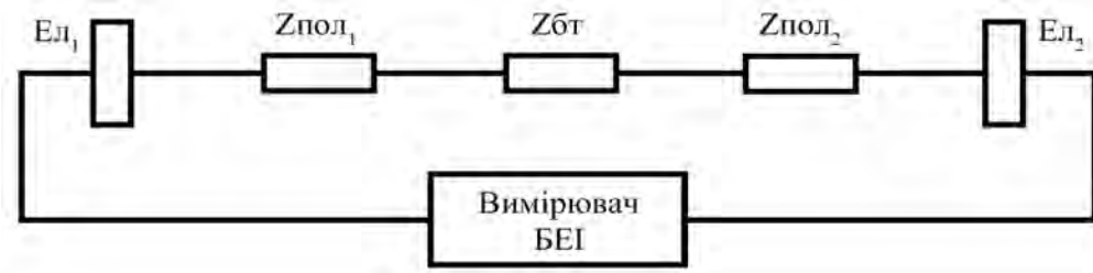
Рис. 3. Еквівалентна схема БЕІМ:
