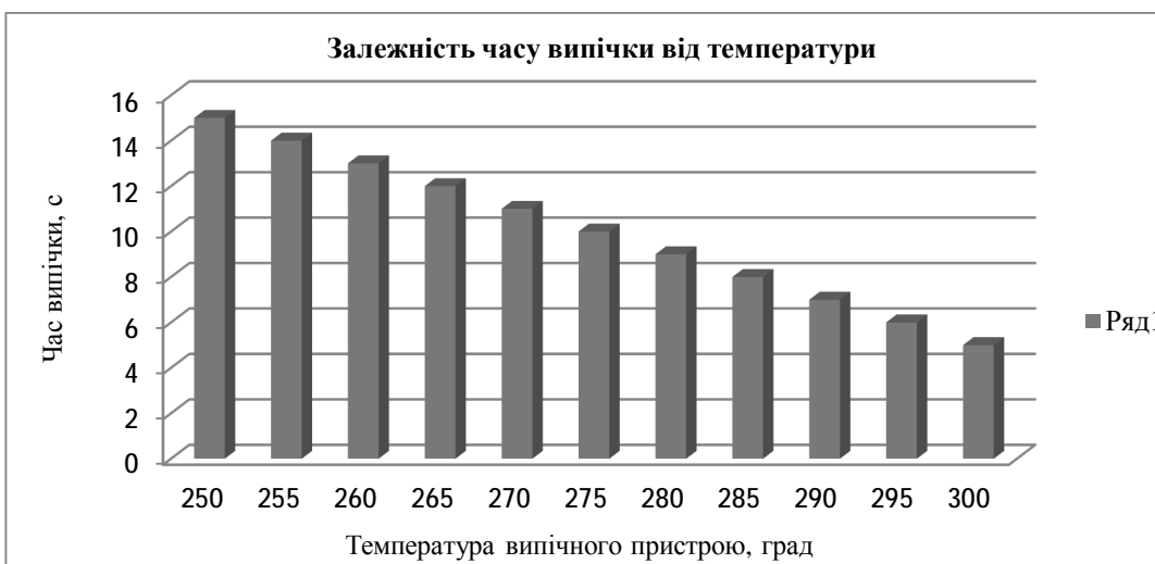
Рис. 6. Залежність продуктивності автомата (часу випічки) від температури випічного пристрою
