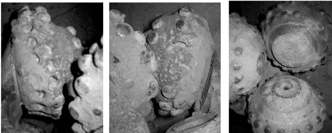
Рис. 3. Характерні руйнування вставного породоруйнівного оснащення доліт
