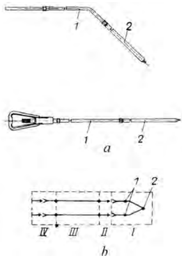
Рис. 5. Перетворювач термоелектричний типу ТПП-2085: а – загальний вигляд; 1 – трубка корпусу термоперетворювача; 2 – пакет із вимірвальною головкою; б – електрична схема; 1, 2 – холодний та гарячий спай термопар, відповідно; I – чутливий елемент пакета; II – контактотримач; III – кабель; IV – роз’єм
