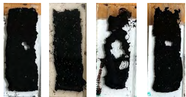
Рис. 4. Вплив тривалості модифікування на адгезійні властивості БМП: а – 30 хв; б – 60 хв; в – 90 хв; з – 120 хв
