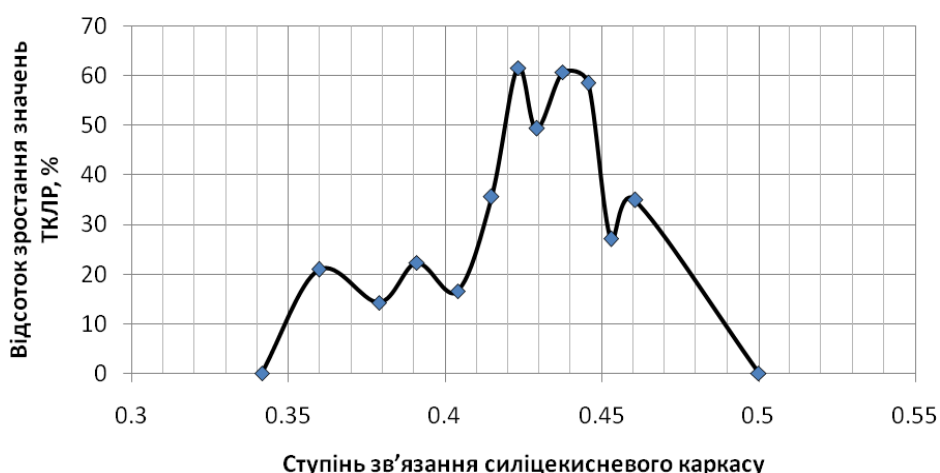
Рис. 3. Залежність відсотка зростання значень ТКЛР в інтервалі склування від ступеня зв'язання силіційкисневого каркаса
