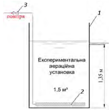
Схема експериментальної установки періодичної дії: 1 – аераційна установка; 2 – аератор; 3 – вентиль
