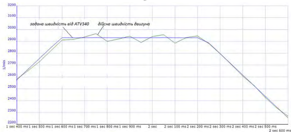
Рис. 3. Тахограма руху приводу Lexium 32C, веденого приводом ATV340: а – тахограми руху двох приводів; б – збільшений фрагмент тахограми руху
