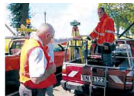
Проведення моторизованого нівелювання I класу
