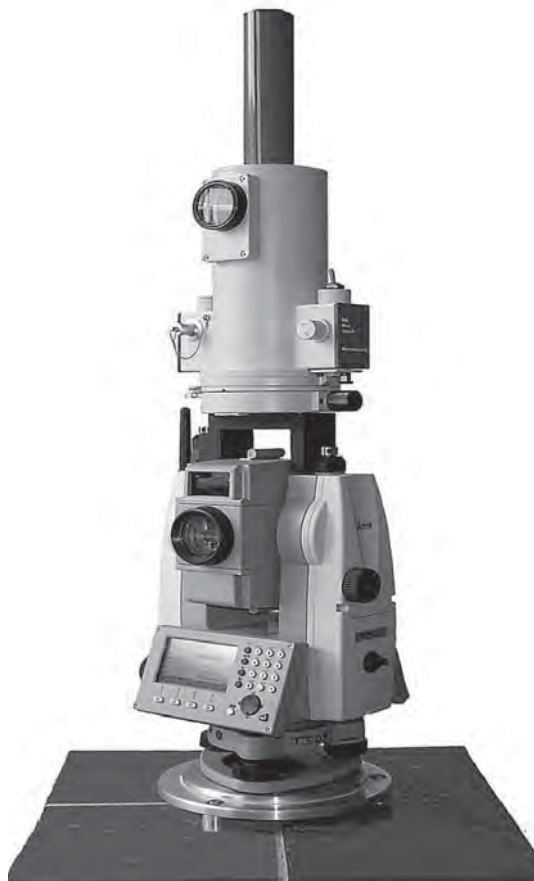
Рис. 1. Гіроскопічний прилад “Gyromax™ AK-2M”
