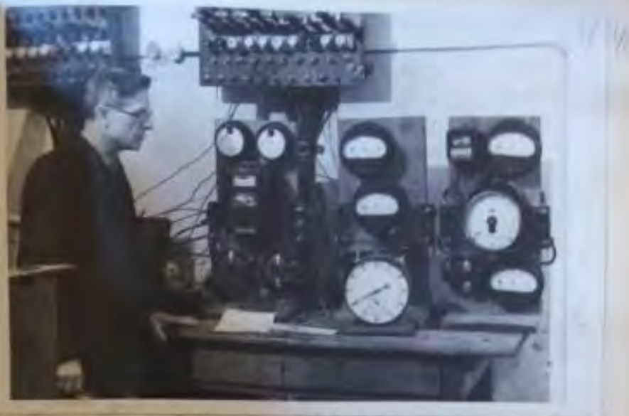
Проф. Ключица В.Н. за проверкой измерительных щитов предназначенных для работы по нормированию потребления электроэнергии в коммунальной промышленности.
