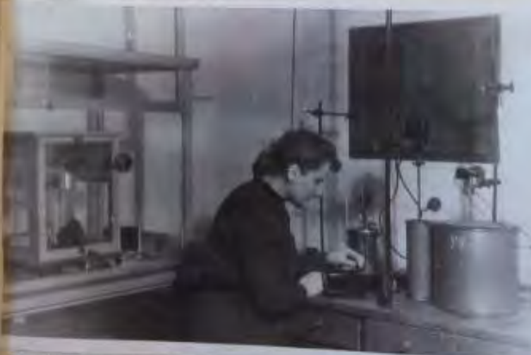
Зав. кафедрой Физической и коллоидной химии Васенко Е.Н. за измерением тепловых эффектов в адиабатическом калориметре
