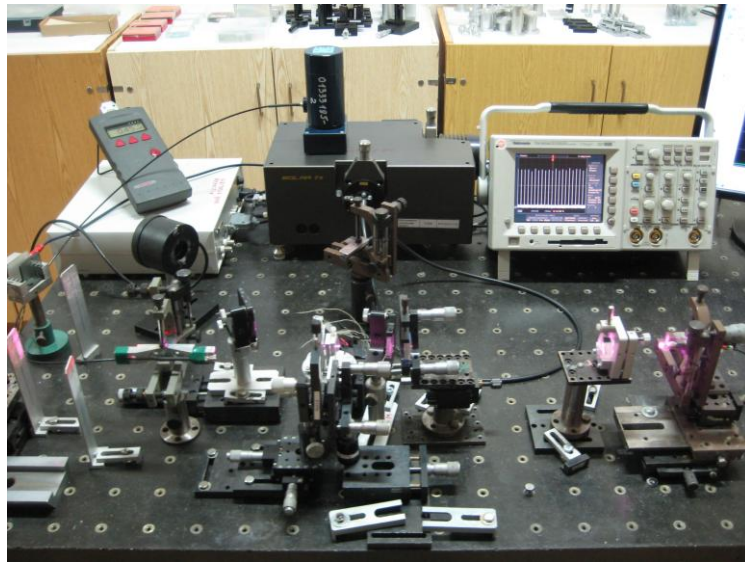
Рисунок 2.28 - Стенд для вимірювання лазерних характеристик включає: набір діодних лазерів для накачування з різною довжиною хвилі та волоконним виходом, фокусуючу систему, модуль реєстрації.
