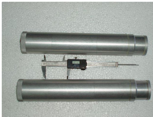
Рисунок 5.6 - Спектрометричні блоки детектування \gamma -випромінювання на основі монокристала вольфрамату кадмію \text{CdWO}_4 .
