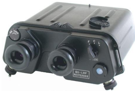
Рисунок 1.1 - Лазерний прилад для вимірювання відстані ( \lambda=1538 нм і E_{\text{імп}}=10 мДж). Розробник - НДІ «Поліус» (Росія).
